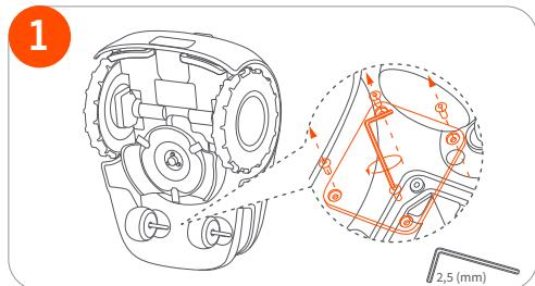
1. Pomocou 2,5 mm imbusového klúča uvoľnite 4 skrutky.
